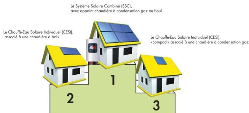
**Pour la maison individuelle neuve, les premiers résultats pour les postes « eau chaude et chauffage » montrent que la solution la plus performante selon le code de calcul de la RT 2012 est le système solaire combiné (avec appoint gaz ou fioul, pour le chauffage et l'eau chaude sanitaire).**
